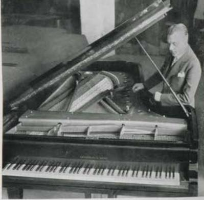
Lösung des Klavierproblems im Rundfunk? Seit je war der Klavierton das Schmerzkind des Rundfunks. Eine Abstellung der bisherigen Klangfehler soll durch eine von dem Hamburger Albert Hiller eingeführte Einrichtung erreicht werden: Ohne Verwendung des Mikrophons wird der Klang durch einen bei den einzelnen Saiten angebrachten elektromagnetischen Tonabnehmer direkt auf den Sender übertragen. Diese neuartige Vorrichtung wurde vor kurzem im Berliner Rundfunk erfolgreich erprobt.
